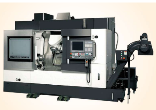
Illustr: Le tour multifonction MULTUS B200II du constructeur OKUMA est conçu de manière à contrôler les effets de la dilatation thermique.
